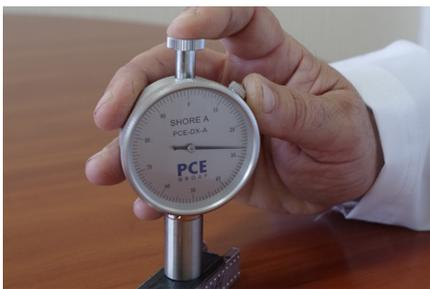
Рис.3. Измерение твердости вторичного герметика по Шору А
