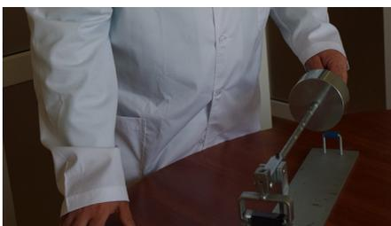
Рис.4. Тест на разрыв. Проверяется адгезия по стеклу и дистанции
