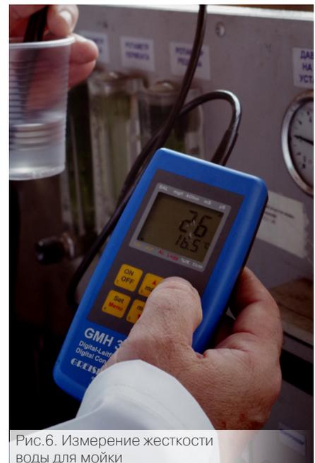
Рис.6. Измерение жесткости воды для мойки
